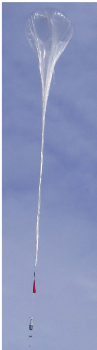
Ballongen er sluppet! Fra topp til bunn: ballongen, søker, avkoplingsenhet, fallskjerm (rød), antenne til navigasjon (GPS) og kommunikasjon (IRIDIUM), nyttelast, ballast, solpanel, radarreflektor og til slutt et magnetometer.
