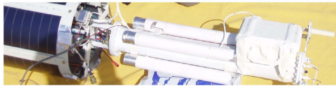
Trykket i ballonghøyden er over 100 ganger lavere enn ved jordoverflaten og temperaturen er lav. Nyttelasten er innkapslet i en tett boks for å beskytte mot det lave trykket. Tross minusgrader, er det allikevel nødvendig å beskytte instrumentet mot at det blir for varm! Enkleste måte å forhindre dette, er å male alt hvitt. Da vil innfallende varmestråling fra sola bli reflektert.
