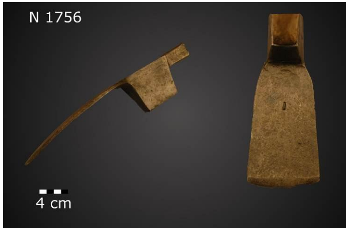
Figur 4.14: Teksle produsert av Parker & Son, Sheffield. Foto: Ingar Figenschau. Gjenstanden tilhører Tromsø Museum, Universitetsmuseet.
