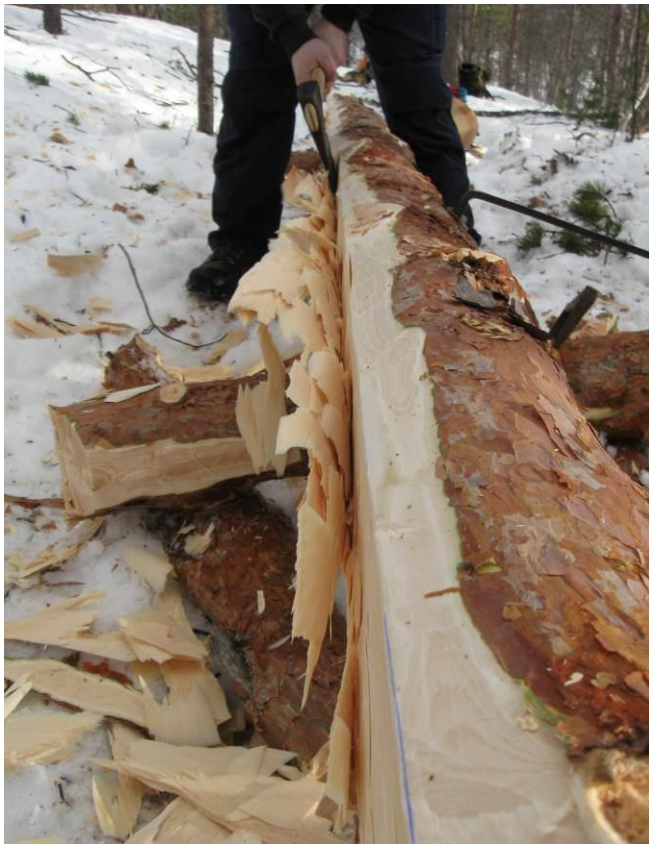
Figur 4.11: Roald Renmælmo ryr (sletthugger) tømmer med bile. Foto: Ingar Figenschau.
