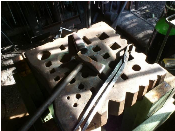
Figur A4: Senkeambolt med dor, meisel og tang. Foto: Ingar Figenschau.
