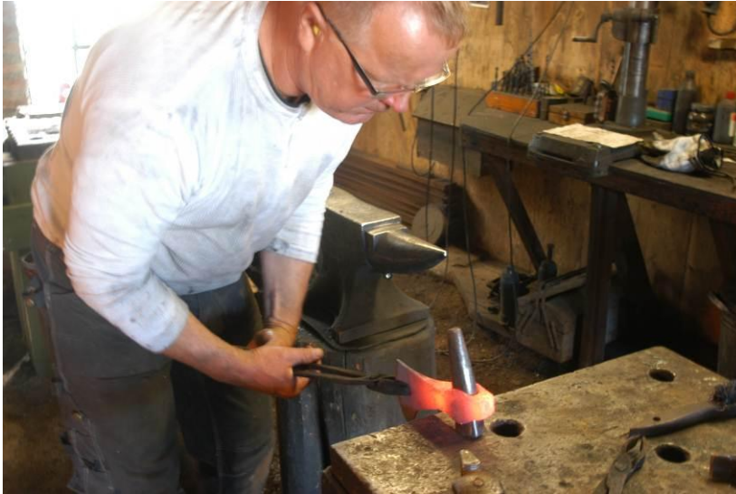
Figur A6: Øystein Myhre med økseemnet og dor. Foto: Ingar Figenschau.
