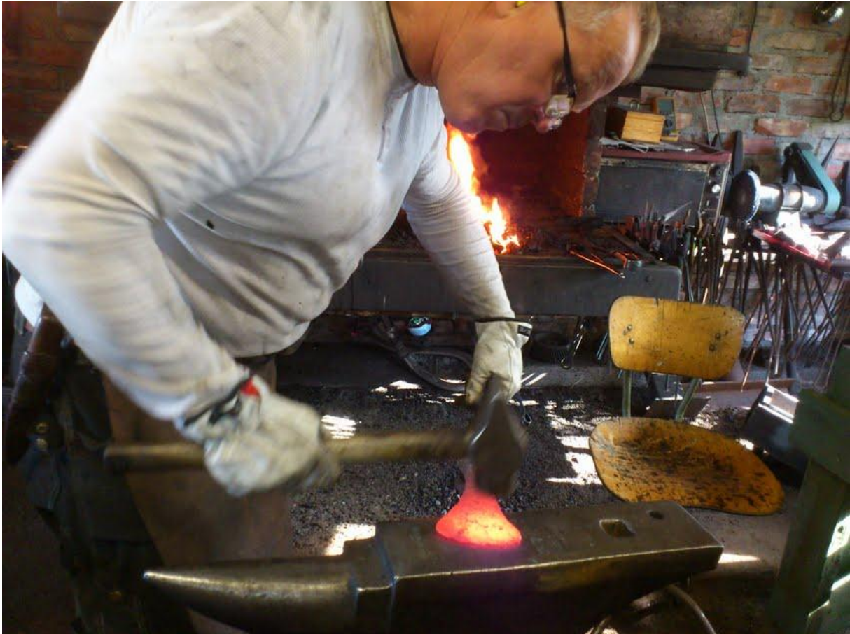
Figur 3.2: Smed Øystein Myhre i bearbeidelse av økseemnet. Foto: Ingar Figenschau.
