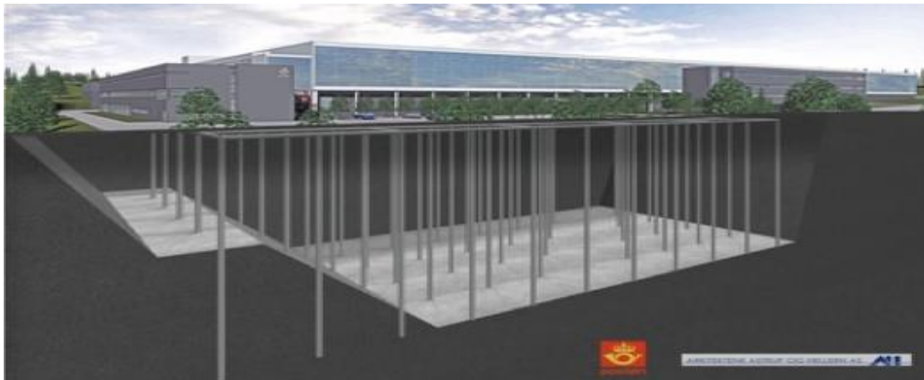
Figur 1: Skissering av et geotermisk system ved den nye postterminalen på Lørenskog [IEA, 2010]
