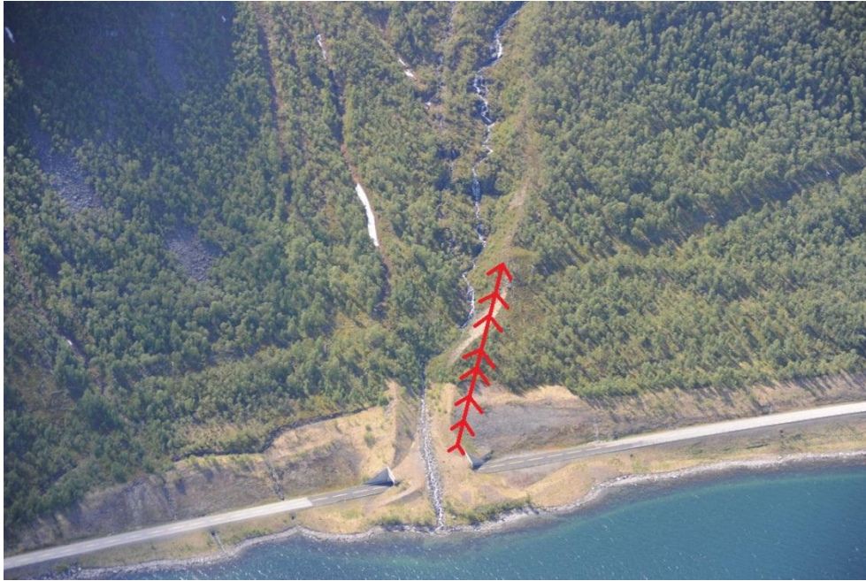
Figur 29 Flyfoto av overbygg ved Njirran Øst. Alternativ utforming av skredvoll er markert i rødt. Tilpasset foto fra Statens Vegvesen
