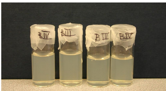
Illustrasjon 23: Tyndall-prøver hvor alle ser like ut (de to prøvene til venstre er av samme parallell (BIV=vann), og de to til høyre er av samme parallell (BIV=vann))
