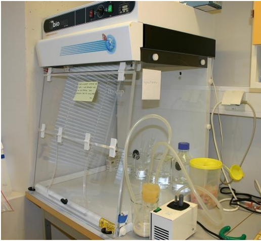
Illustrasjon 8: LAF-benken hvor tilbereding av prøvene av vannfasen ble gjort
