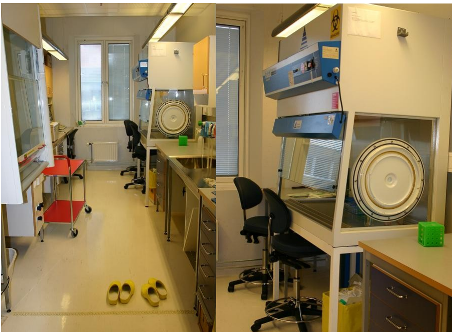
Illustrasjon 6: Laboratoriet som vi brukte som «renrom», med illustrasjon av ren og uren side Illustrasjon 7: LAF-benken hvor legemidler ble tilberedt og prøvene ble laget
