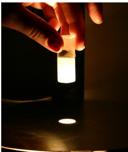
Illustrasjon 16: Tyndall-rør gjennomlyst med Tyndall-lampen
