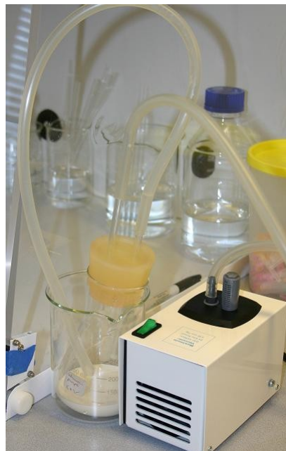
Illustrasjon 15: Vakuumpumpen som kobles til en pipette (står utenfor LAF-benken)
