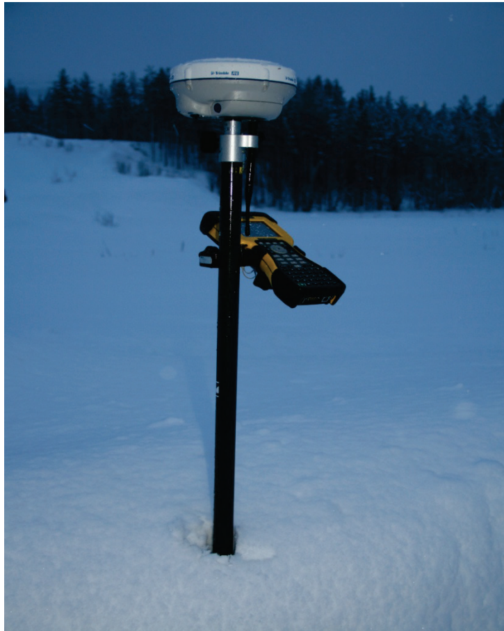
Figur 2 – 1 viser GPS brukt til høydemåling .
