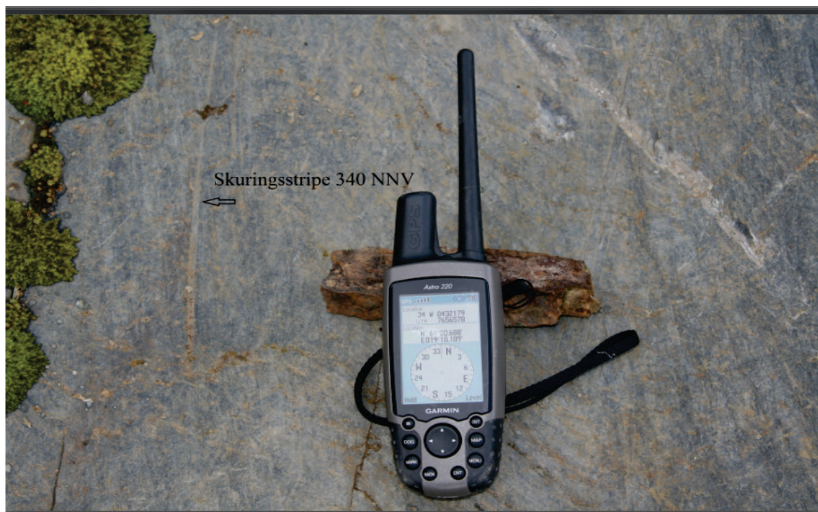
Figur 3 – 3 b). Orientering på skuringsstriper, målt til 340° NNV. Skjærhaugen hoppbakke.
