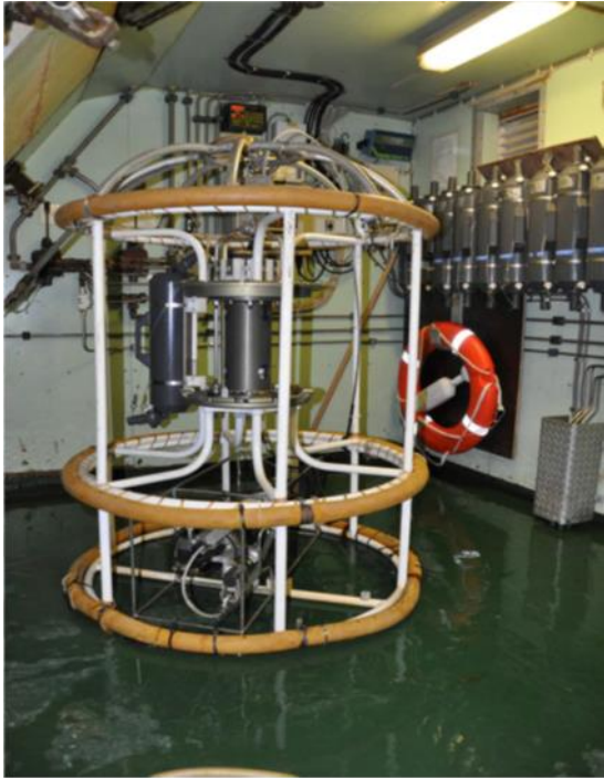
Figur 2.2: Bildet viser en CTD-rosett montert på en ramme. CTD instrumentet sees som en sylinder i midten, mens til venstre sees en vannbeholder. Foto: Matthias Forwick, Uit
