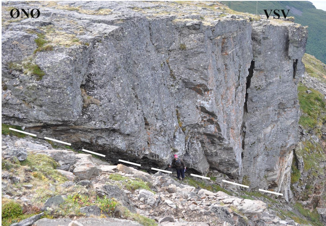
Fig. 33 Vertikalplanet til sideskrenten ved Indre Nordnes indikert ved ei stipla linje som separera terrassen/blokka frå den intakte berggrunnen i tillegg til overgangen mellom granatglimmergneisen og kalksilikatgneisen som kan verta observert nedst til høgde
