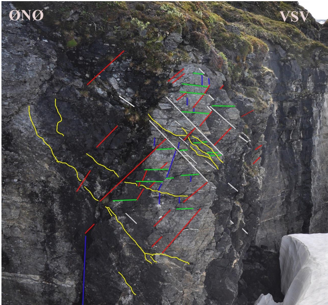
Fig. 32 Ulike sprekkesystem i vertikalplanet til den NNV-SSØ strykande baskrenten der horisontale (grøn), vertikale (blå), antitetiske (raud), diagonale (kvit), listriske (gul) og konjugerte sprekkesett er markert (raud og kvit)
