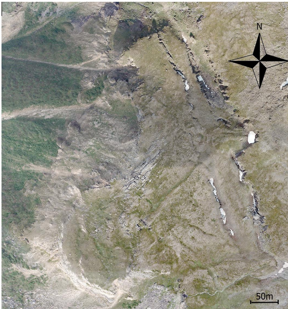
Fig. 15 Oversiktskart over skredområde Midtre Nordnes avgrensa av ein steil NNV-SSØ orientert skrent i bakkant med fall mot VSV i tillegg til ein parallell antiskrent i forkant som heller mot ØNØ tolka til å vera ein grabenstruktur der terrasser, skråningar, storskala lineament, skrentar og sprekkesystem pregar område i forkant av grabenstrukturen.
