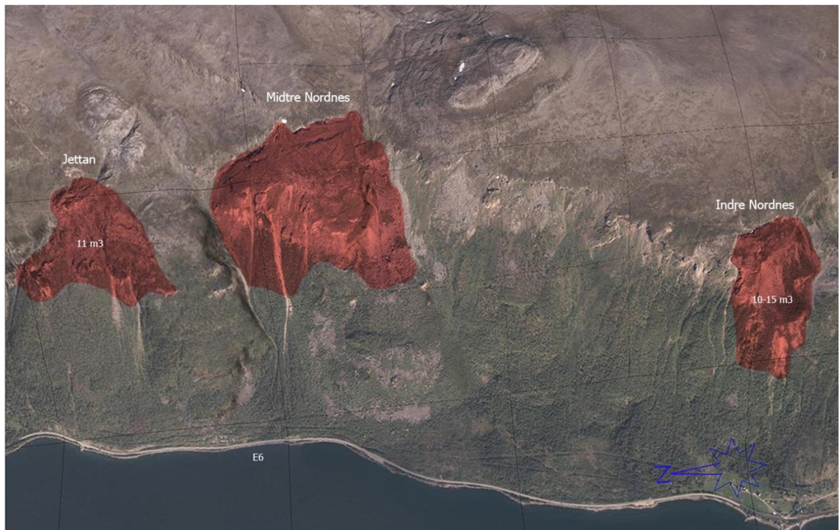
Fig. 13 Oversiktskart over Nordnesfjellet med inndeling i skredområda Jettan, Midtre- og Indre Nordnes med E6 like under og Lyngenfjorden i retning vest
