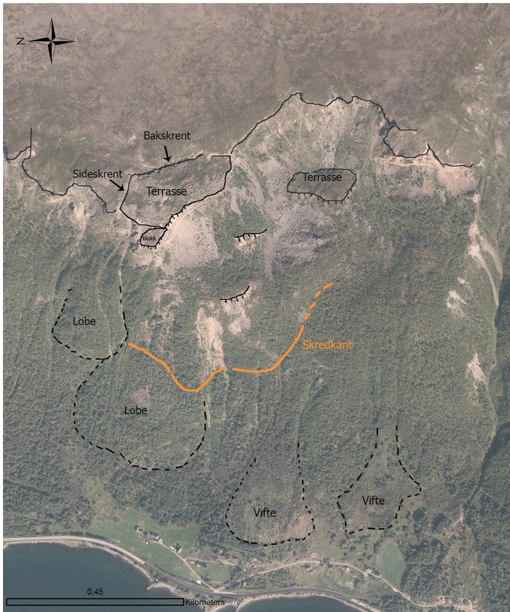
Fig. 14 Oversiktskart over skredområde Indre Nordnes med kartlagde storskala formelement i form av skrentar, terrasser og lausmassar
