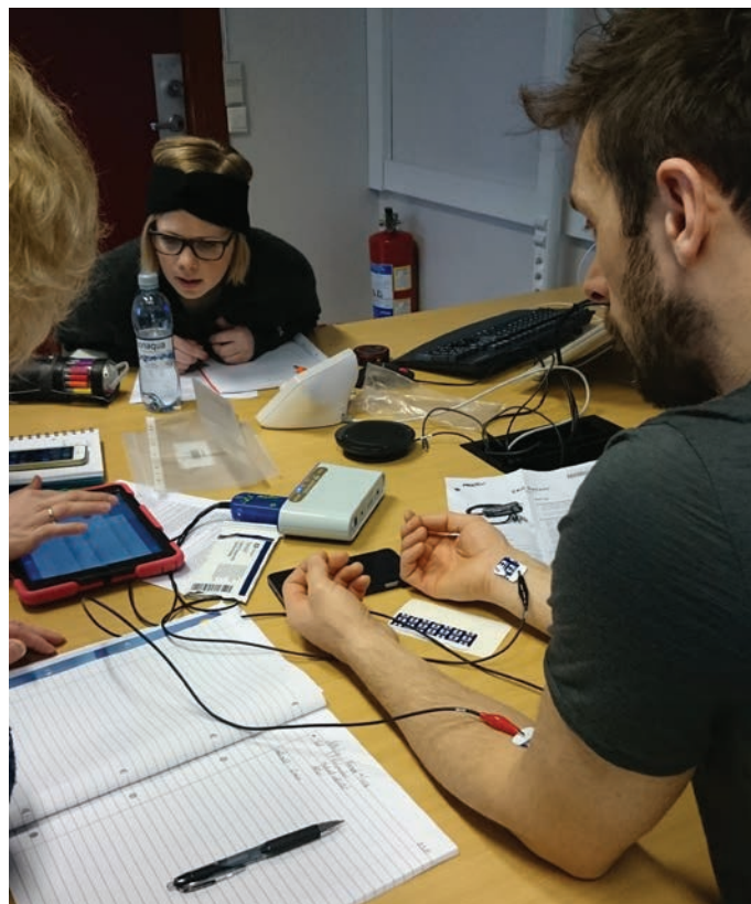
EKG-måling. En sensor kobles til en overføringsenhet (grå boks i midten), som kommuniserer trådløst med iPad (til venstre) via Bluetooth.
